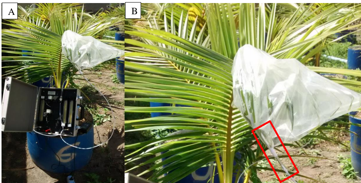
Figura 12 – Coleta de voláteis de coqueiro em campo, Rio Largo-AL 2016. A) Sistema de aeração montado em campo; B) Saco de polietileno coletor de voláteis com “trap”.
